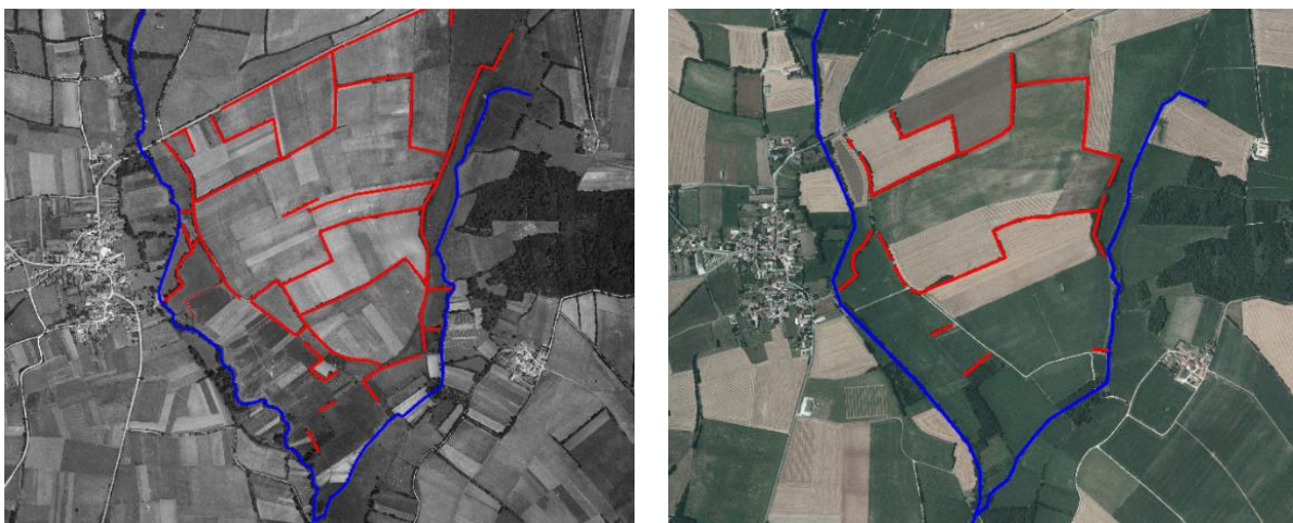
FIGURE 17 : CARTE D'ÉVOLUTION DU CHEVELU HYDROGRAPHIQUE (EN BLEU) ENTRE 1950 ET 2000 PAR RECTIFICATION, RECALIBRAGE (SOUS-BASSIN DE L'AUME-COUTURE) - © IGN
