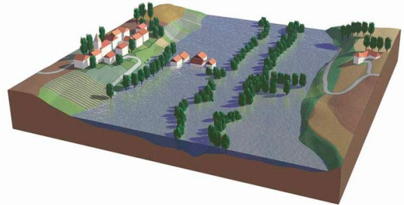
Pour les petites crues, l'inondation s'étend dans le lit moyen et submerge les terres bordant la rivière. Lors des grandes crues, la rivière occupe la totalité du lit majeur
