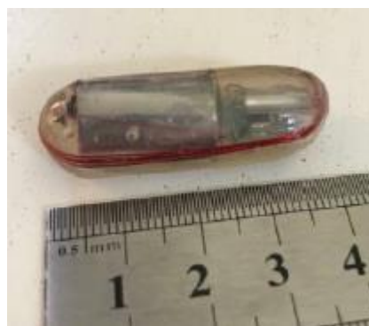
Figure 33 : Marque radio ATS F1210 utilisée pour le suivi
