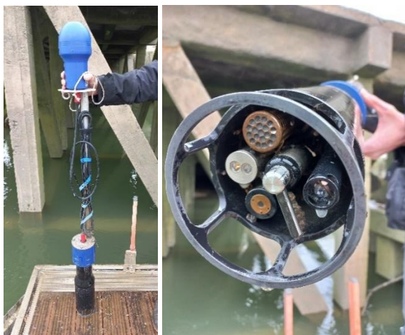
Figure 5 : Photographies prise lors du nettoyage de la sonde Wimo sur la Charente à Tonnay-Charente (@Lise-Andro)
