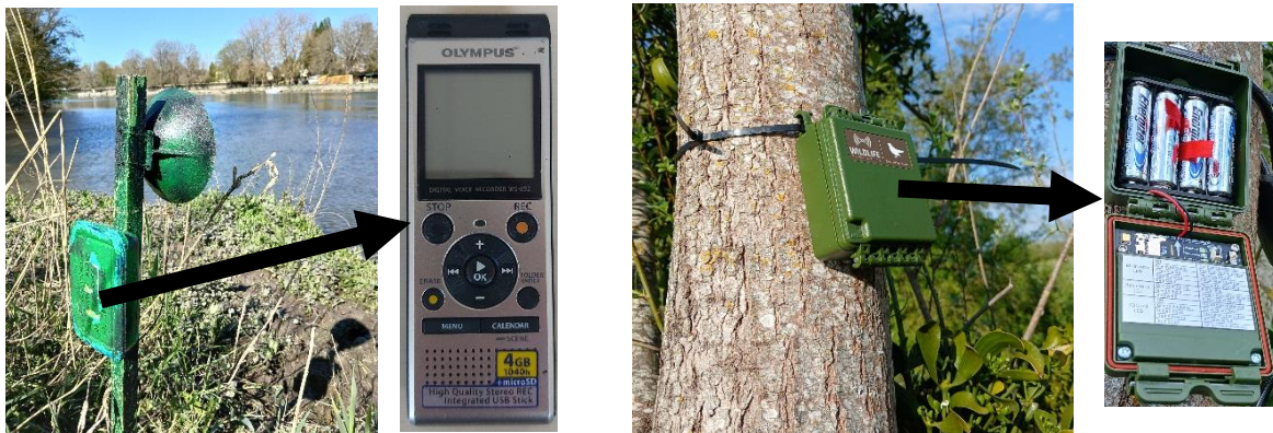
Figure 4. Enregistreur OLYMPUS (à gauche) contenu dans le boîtier, avec parabole et enregistreur SMM (à droite) installé dans un arbre face à la frayère (photos ©Audrey Postic-Puivif).
