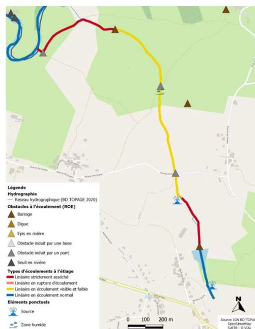
Figure 27 : Impact d'un plan d'eau sur la continuité des écoulements (source : SyBTB)
