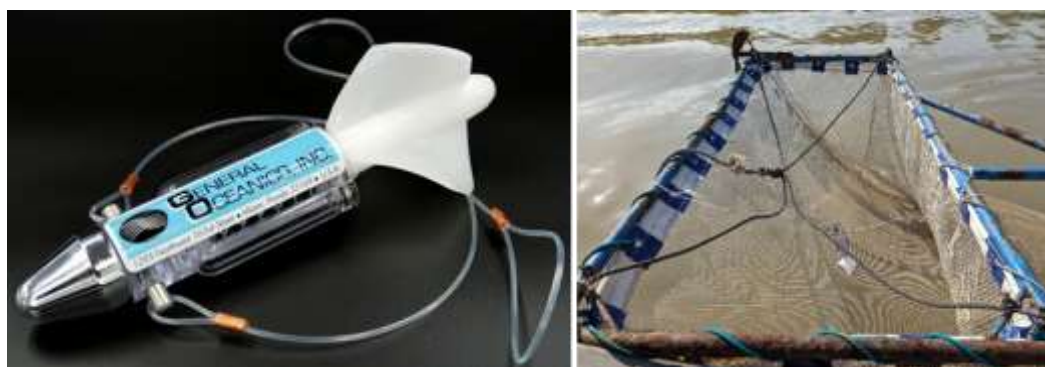
Figure 11 : Débitmètre utilisé pour le suivi estuarien et installé sur un des cadres.
