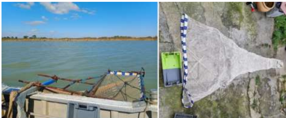
Figure 9 : Cadre (à gauche) et filet (à droite) utilisés pour l'échantillonnage en partie estuarienne.
