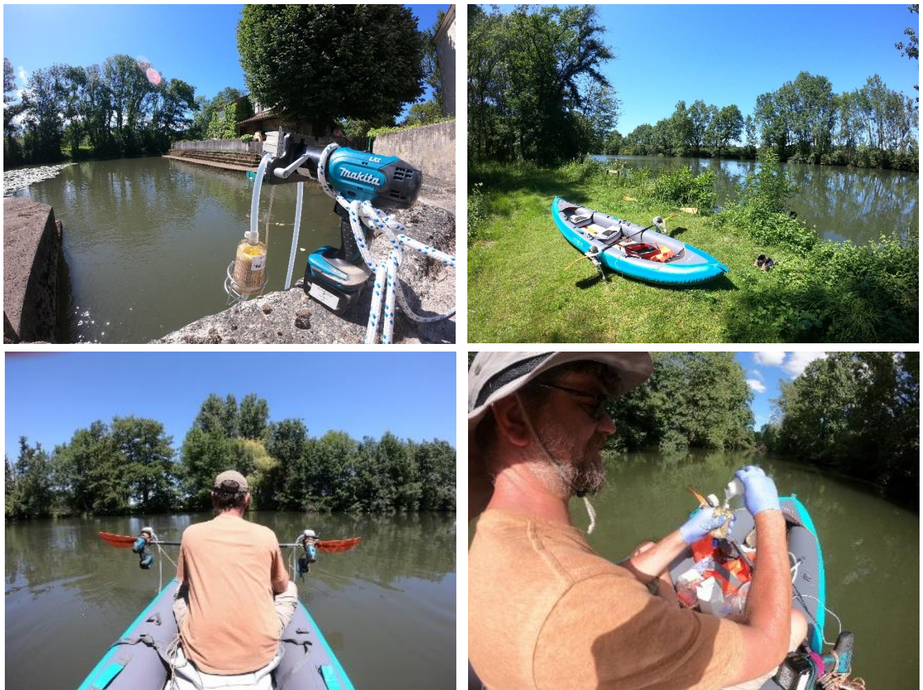
Figure 14 : Protocole d'échantillonnage terrain. Pour le prélèvement embarqué, les deux pompes étaient lancées simultanément, fixées de part et d'autre du canoë sur une pagaie, à distance de la coque et à l'amont pour éviter les contaminations
