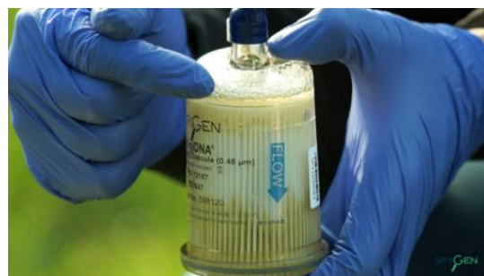
Figure 9 : Illustration de la capsule de filtration 0.45 \mu m VigiDNA®, avec une surface totale de 500 cm 2 permettant la filtration de 30 litres d'eau.
