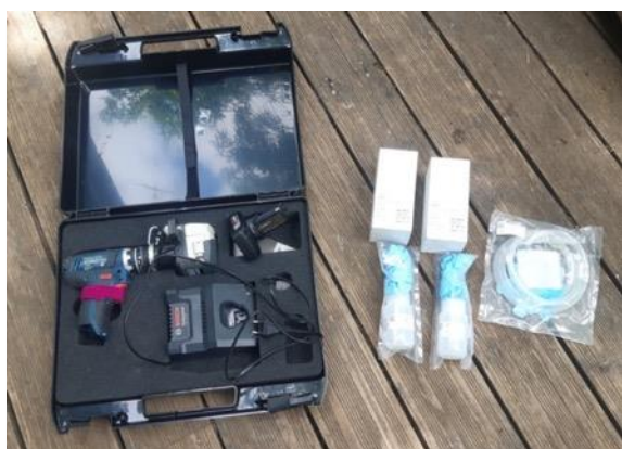
Figure 10 : Matériel de prélèvement : pompe péristaltique montée sur une visseuse, filtres, bocaux de tampon et tuyau ; le tout garanti DNA-free.
