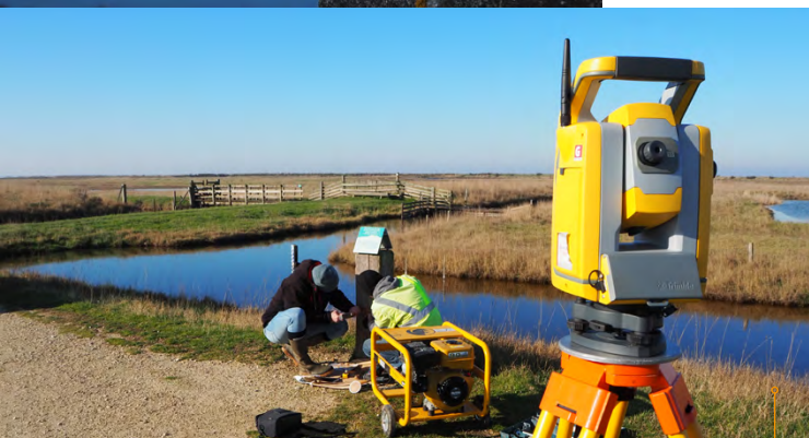
Matériel topographique déployé par les agents de Synergéo afin de positionner les repères.
