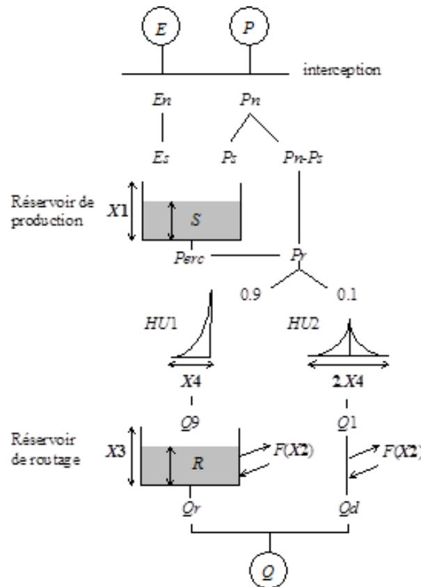
Figure 61 : Schéma de fonctionnement du modèle GR4J
