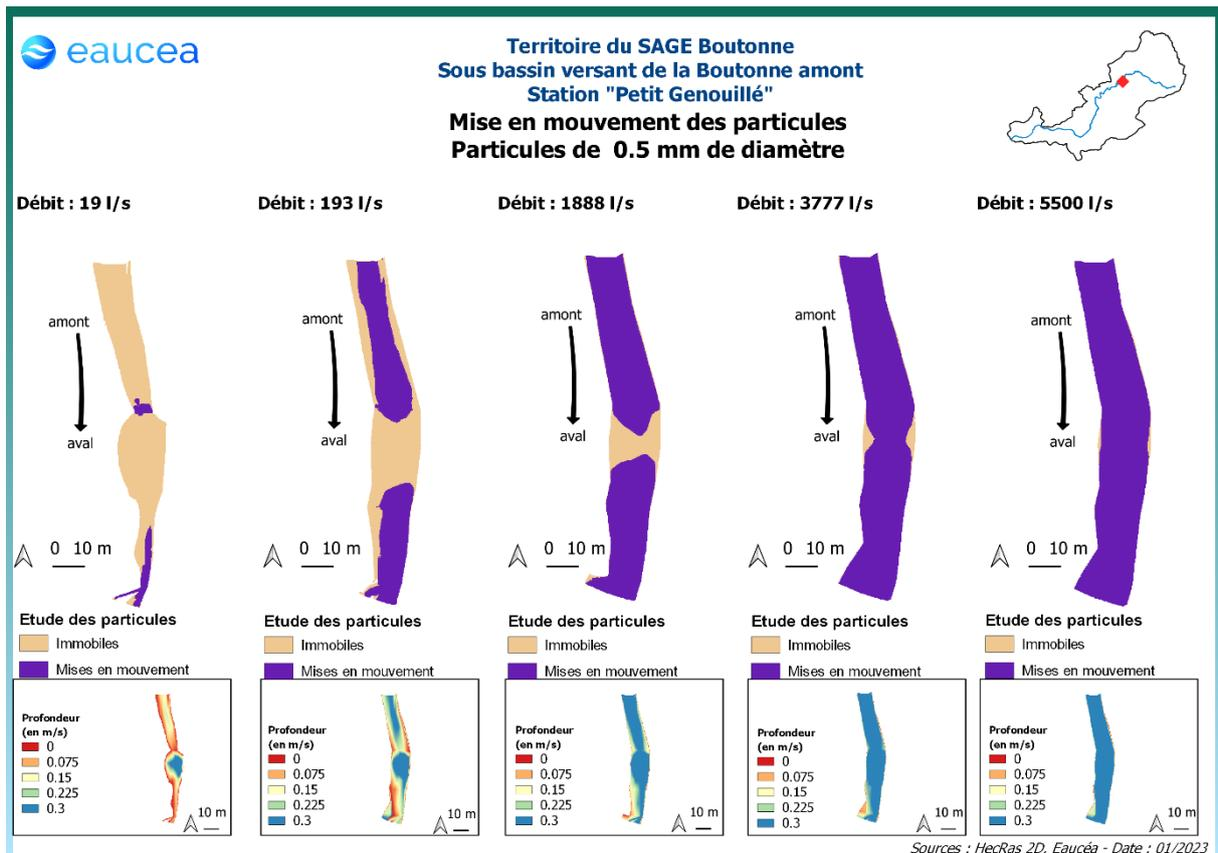
Figure 15 Exemple de cartographie des mouvements sédimentaires
