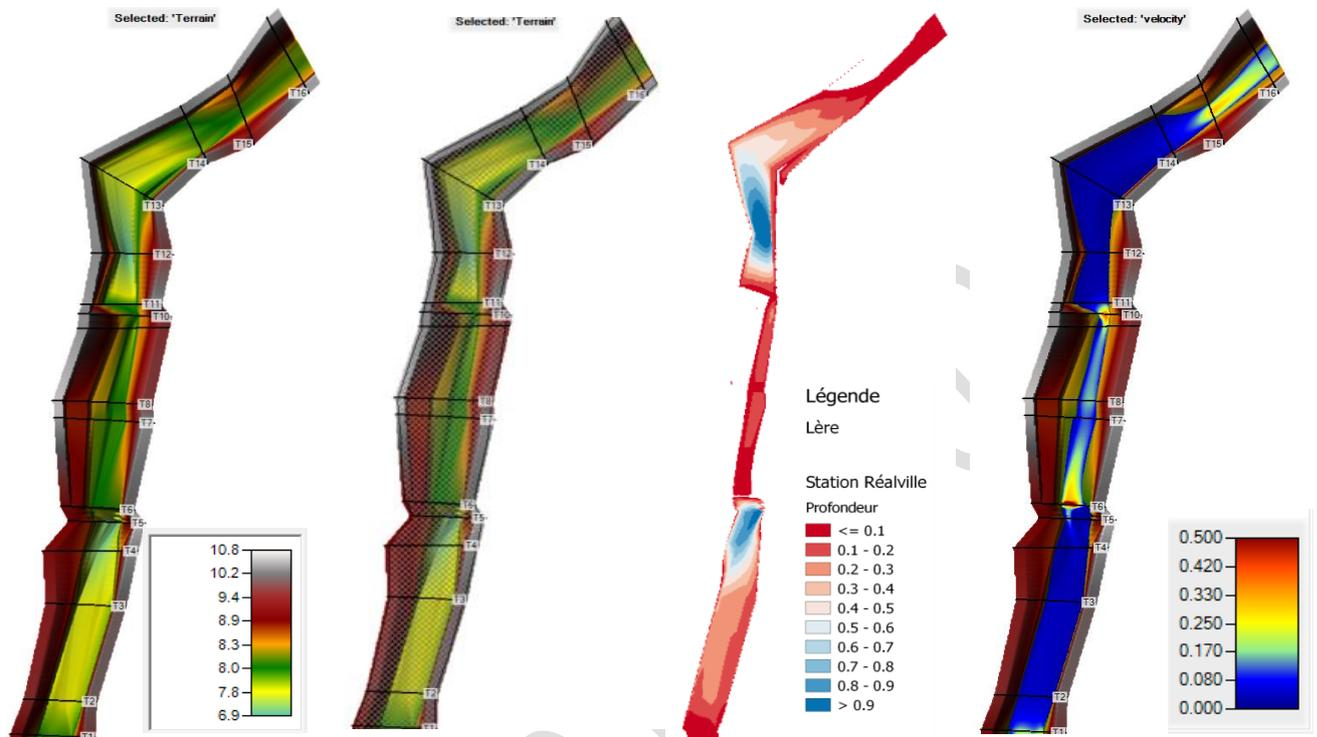
Figure 23 : (de gauche à droite) Topographie du tronçon/ Topographie avec ajout du maillage 2D pour le modèle hydraulique/ Résultats des simulations pour la hauteur d'eau (m) / Résultat simulation pour la vitesse (m/s). Source: Eauce.
