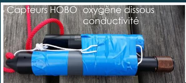
Capteurs HOBO oxygène dissous
