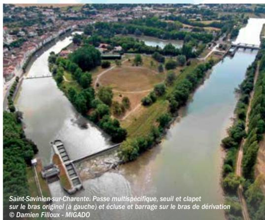
Saint-Savinien-sur-Charente, Passe multispécifique, seuil et clapet sur le bras original (à gauche) et écluse et barrage sur le bras de dérivation © Damien Filloux - MIGADO
