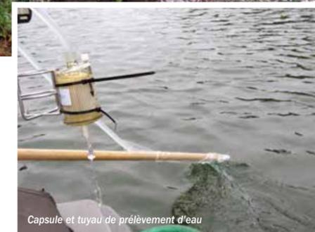
Capsule et tuyau de prélèvement d'eau
