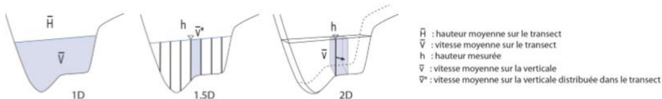
Figure 14: Schéma de comparaison entre modèles 1D, 1,5D, 2D. Source : Prost et al., 2014.
