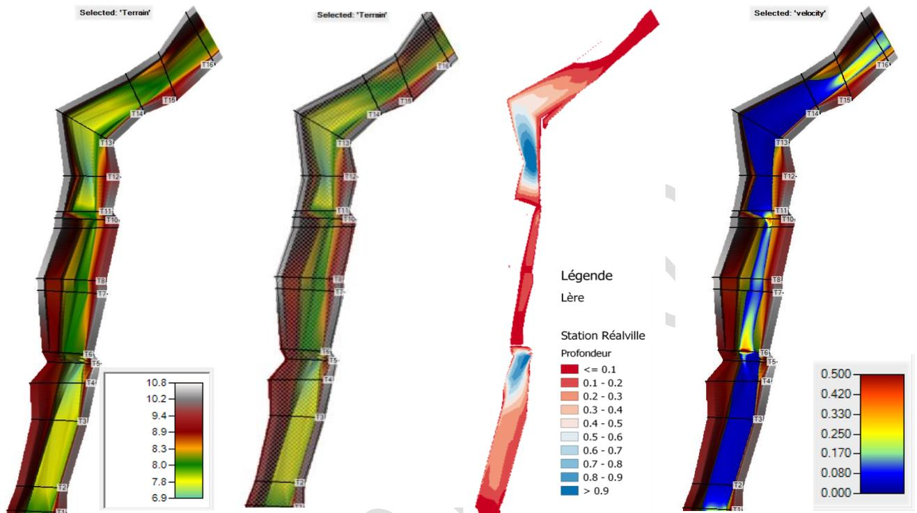
Figure 15 :(de gauche à droite) Topographie du tronçon/ Topographie avec ajout du maillage 2D pour le modèle hydraulique/ Résultats des simulations pour la hauteur d'eau (m) / Résultat simulation pour la vitesse (m/s). Source: Eaucea.
