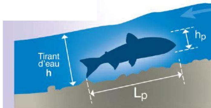
Figure 5 : Tirant d'eau nécessaire pour le franchissement des poissons, issu du guide ICE de l'ONEMA (2014)
