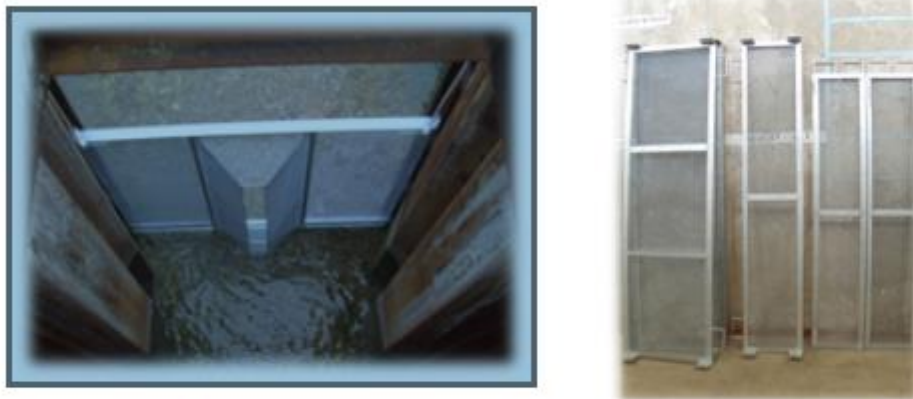
Figure 2 : Nasse anti-retour (gauche) et grilles de blocage amont. MRM/CNR
