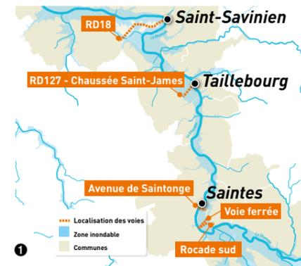
Portée par l'EPTB Charente, cette étude consistait à **simuler l'impact sur la réduction du risque d'inondation de la réalisation d'ouvrages de décharge** dans les voies traversant le lit majeur de la Charente de Saintes à Saint-Savinien. La plus-value de protections locales à Saintes a également été testée. L'outil de modélisation hydraulique développé a permis de fournir **des réponses rationnelles aux collectivités locales**.
