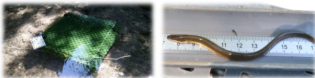
Figure 7 : A gauche, un Flottang sous la surface d'un cours d'eau. A droite, la gamme de taille ciblée par le dispositif (<15 cm), ici une anguille d'une douzaine de centimètres. (Source personnelle)
