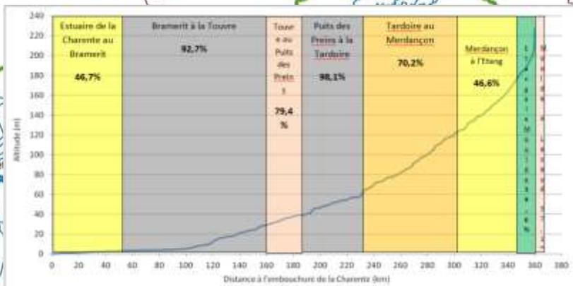
**Axe Charente** : 65% du dénivelé de la source à l'embouchure est contrôlé par des seuils et barrages
