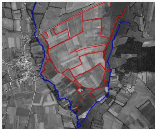
Figure 19 : Carte d'évolution du chevelu hydrographique (en bleu) entre 1950 et 2000 par rectification, recalibrage (sous-bassin de l'Aume-Couture) - © IGN
