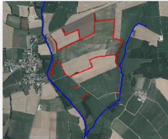
Figure 19 : Carte d'évolution du chevelu hydrographique (en bleu) entre 1950 et 2000 par rectification, recalibrage (sous-bassin de l'Aume-Couture) - © IGN
