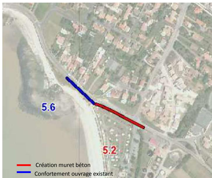
Au stade étude préalable de définition des protections il est envisagé le confortement à l'ouest de l'ouvrage existant et la création à l'est d'un muret béton accompagné de protection amovible sur les accès existants. Le scénario à retenir pourra faire l'objet d'ajustements notamment dans le tracé des protections au stade des études Avant-Projet et PROjet. La problématique d'évacuation hydraulique de la zone sera étudiée lors de l'étude de projet.
