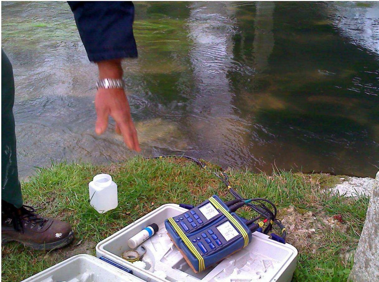
*Mesures de paramètres in situ (sondes)*
