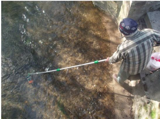
Prélèvement d'eau sur le terrain
