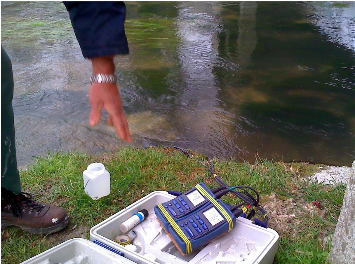
*Mesures de paramètres in situ (sondes)*
