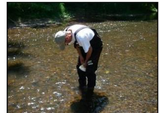
Le matériel benthique a été récupéré par brossage de substrats durs naturels, mis dans des piluliers, formolé *in situ*. Les récoltes ont été dûment étiquetées et apportées au laboratoire Bi-Eau à Angers qui est chargé de la détermination et de l'analyse des ces prélèvements.
