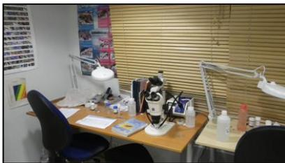
Les prélèvements sont triés au travers de tamis d'ouverture de 10 mm à 500 µm. Le prélèvement est scindé en plusieurs fractions. Dans chaque fraction, les invertébrés sont triés et regroupés dans des piluliers avant identification.
