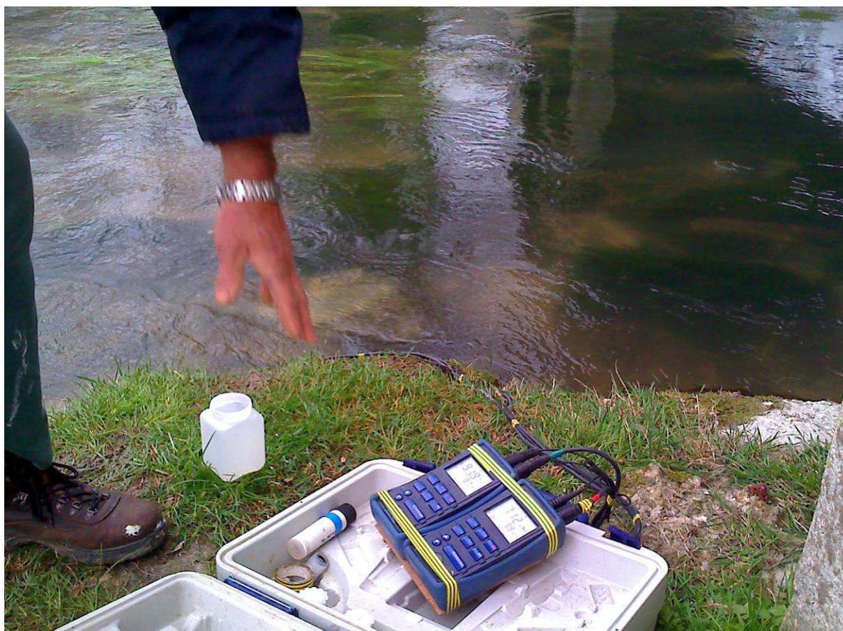
*Mesures de paramètres in situ (sondes)*
