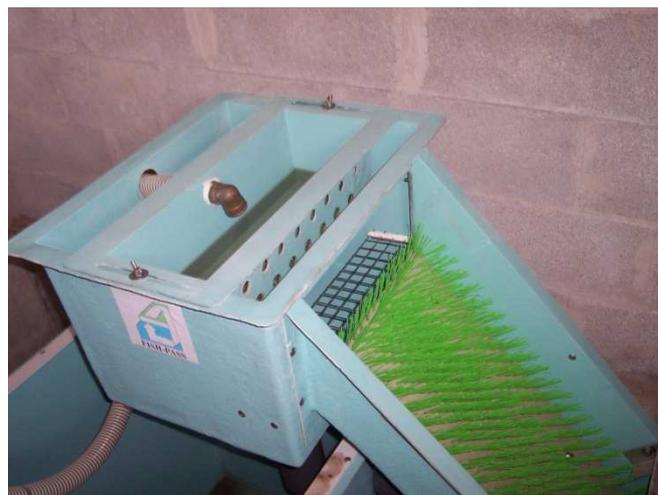
Figure 72 : Photos de la passe piège anguilles de Saujon (brosse extérieure et piège)
