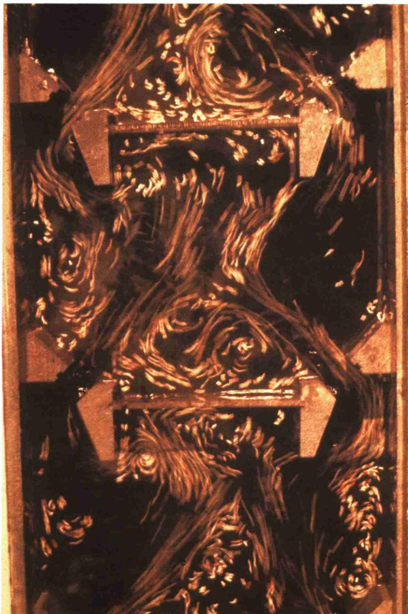
Visualisation sur modèle réduit de l'écoulement
