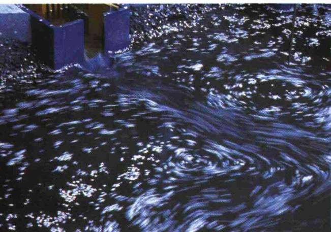
Visualisation sur modèle réduit de l'écoulement à l'entrée de la passe à poissons à l'usine du Ramier sur la Garonne
