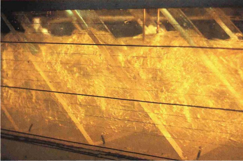
Écoulement sur un modèle réduit dans une passe à ralentisseurs plans
