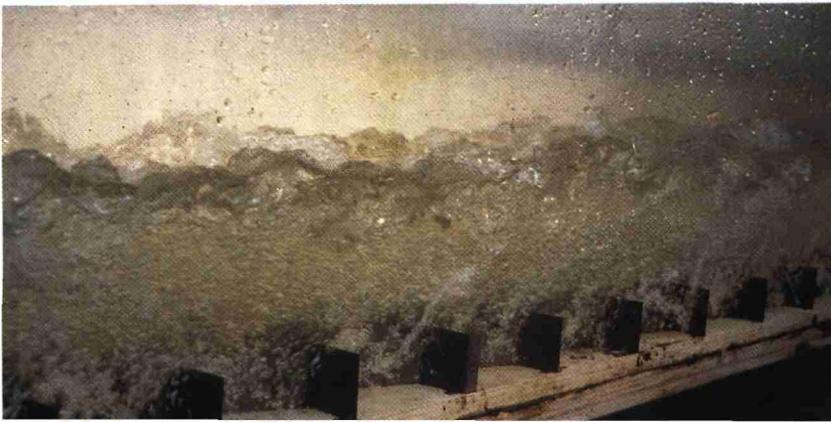
Écoulement dans une passe à ralentisseurs suractifs
