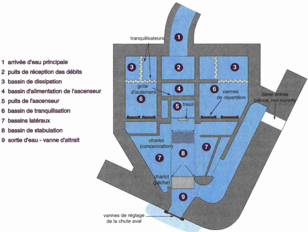
Partie basse d'un ascenseur à concentration des poissons mécanisé :
