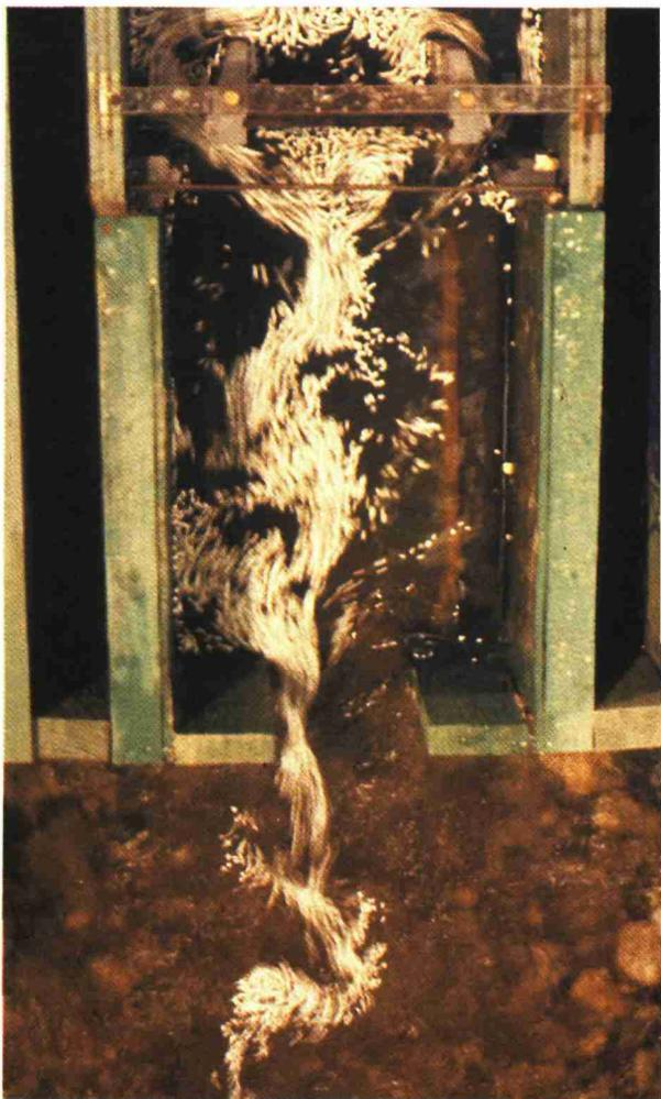
Visualisation sur modèle réduit du pincement de l'écoulement à l'entrée de la passe (vue de dessus)
