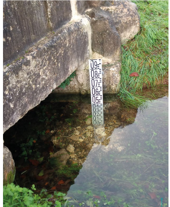
Échelle limnimétrique installée sur L'Anqueville (Graves-Saint-Amant)
