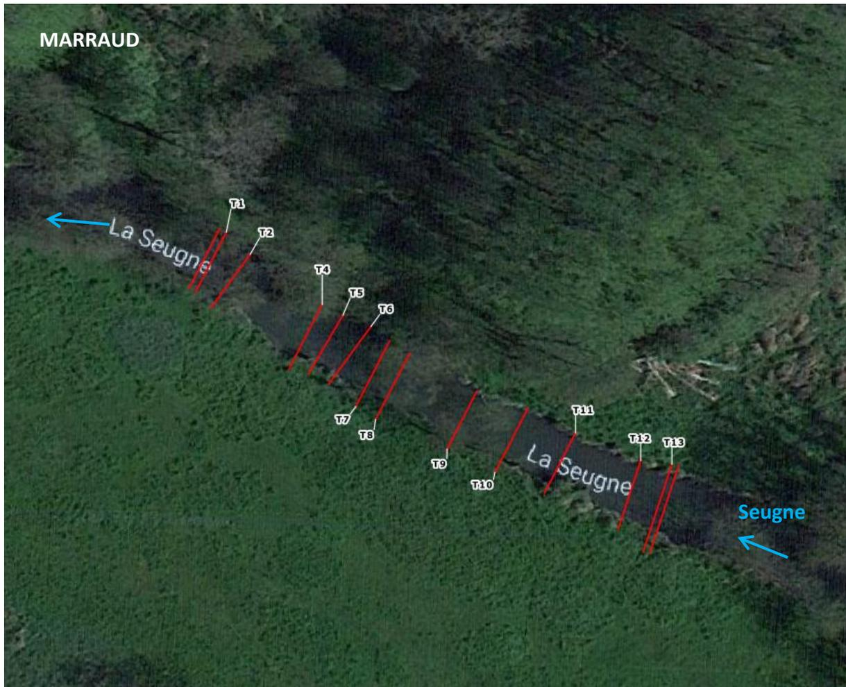
Figure 28 : Position des transects de mesure de la station de débit biologique
